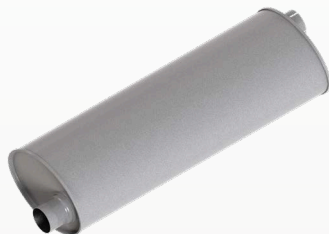
M098 Com Lã de Vidro Tubo Entrada: 4 1/2" (114,3mm) Tubo Saída: 4 1/2" (114,3mm) Largura: 400mm Altura: 305mm Comprimento: 875mm
