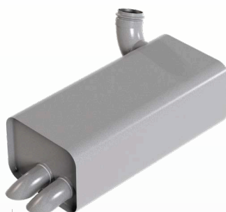
M098 Com Lã de Vidro Tubo Entrada: 4 1/2" (114,3mm) Tubo Saída: 4 1/2" (114,3mm) Largura: 400mm Altura: 305mm Comprimento: 875mm
