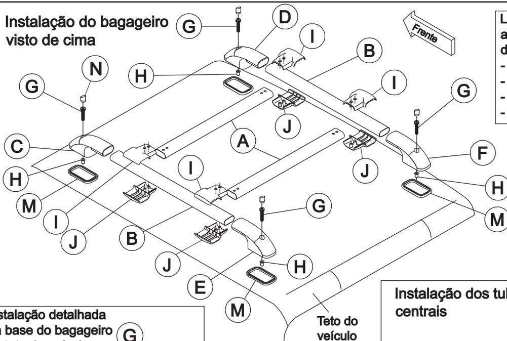
Localizar dentro de cada peça o adesivo que indica qual a posição da base no teto do veículo:
