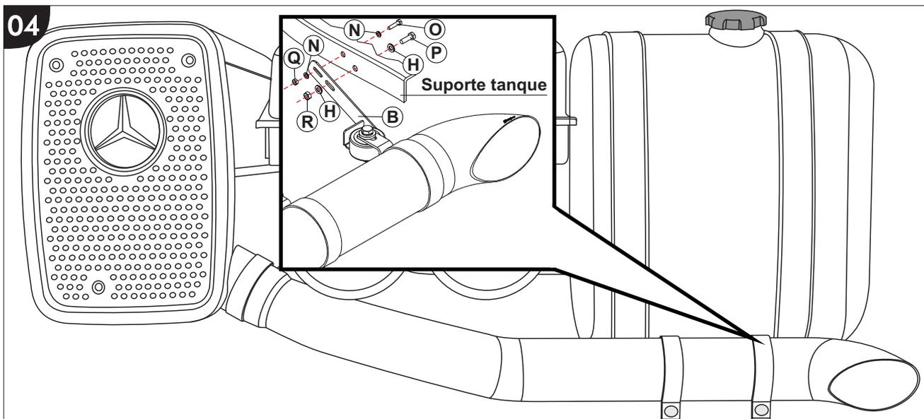
Fixar os suportes «B e C» junto aos suportes de fixação do tanque, utilizando parafusos «O e P», arruelas «N e H», porcas «Q e R», após a montagem finalizada dê aperto total a todos os parafusos do conjunto.
