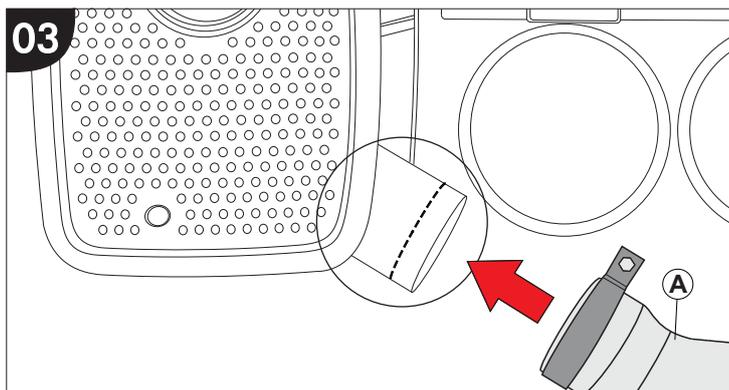
Cortar o tubo de saída do escapamento na medida necessária para montagem, e após encaixar a ponteira «A» junto ao tubo de saída do escapamento.
