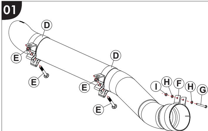
Montar as abraçadeiras «D e F» na ponteira «A», utilizando parafusos «E e G», arruelas «H» e porcas «I», não dê aperto total aos parafusos para facilitar a montagem no veículo.
