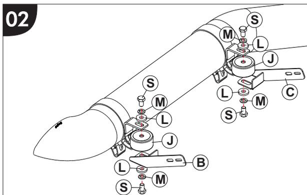
Fixar os suportes «B e C» junto as abraçadeiras «D», colocando entre os calço de borracha «J», utilizar para fixação parafusos «S» e arruelas «L e M», não dê aperto total aos parafusos.
