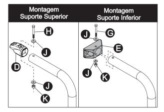
Montagem do Suporte Superior no Veículo Posicione a escada nos pontos de fixação, marque os pontos e após fure utilizando broca Ø8,5mm. Fixe com parafusos, arruelas e porcas, conforme ilustrado.
