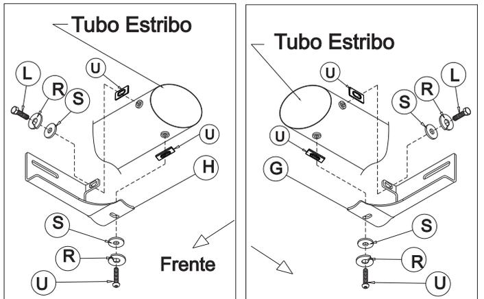
Detalhe p/ posicionamento trava na parte inferior traseira.
