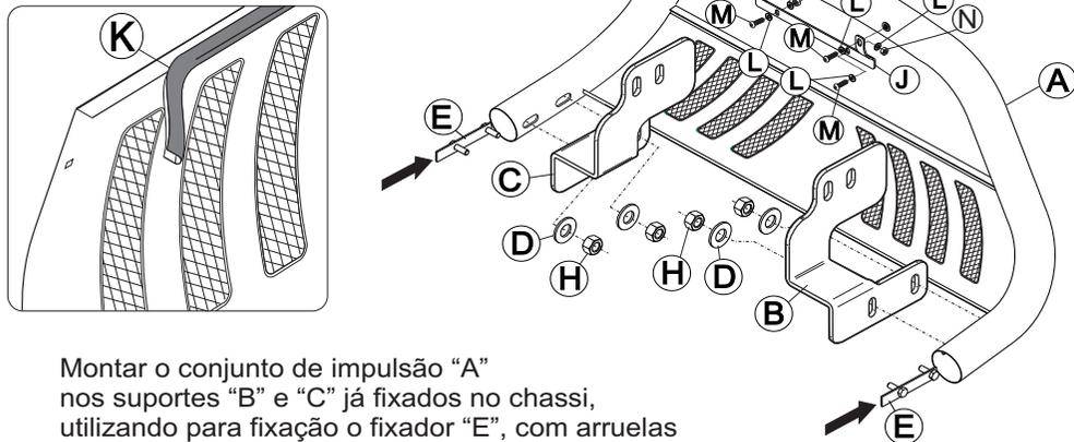
Montar o conjunto de impulsão "A" nos suportes "B" e "C" já fixados no chassi, utilizando para fixação o fixador "E", com arruelas "D" e porcas "H".
