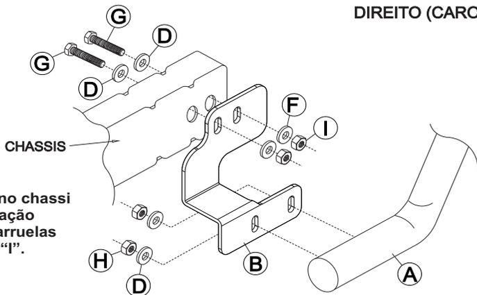
Montar o suporte no chassi utilizando para fixação os parafusos "G" arruelas "D" e "F" e porcas "I".
