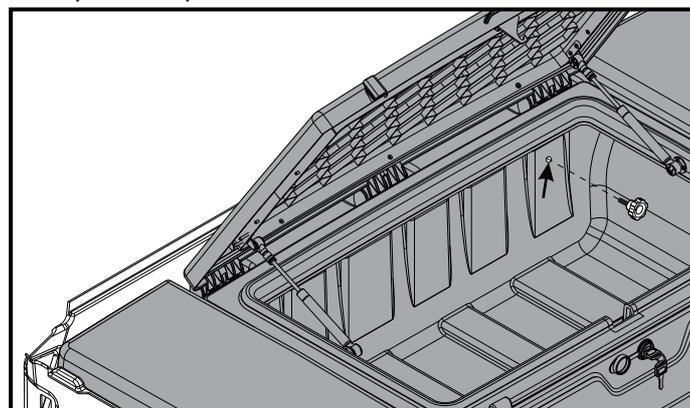
6- Realizar furação na parte inferior do protetor, furando a caixa e o protetor utilizando broca Ø 9mm.
