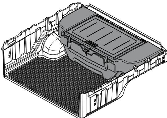
2- Após posicionada a caixa, fazer a furação na parte posterior do protetor de caçamba, furando a caixa e o protetor, utilizando broca Ø 9mm.
