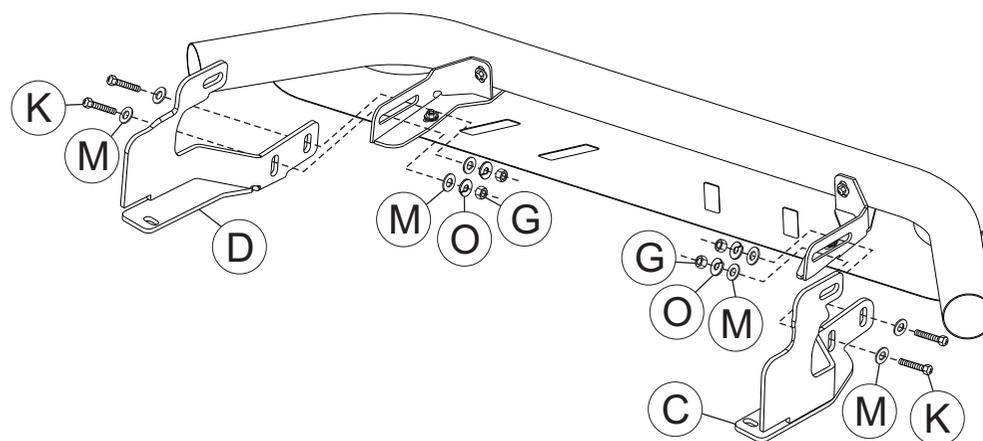
4- Montar os suportes «C e D» nos suportes «E e F» utilizando os parafusos «K», arruelas «M e O» e porcas «G».
