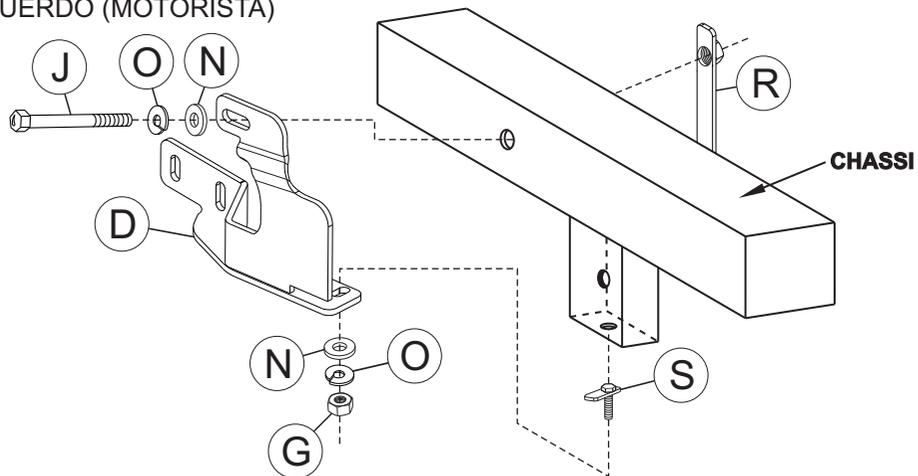
1- Montar os suportes «C e D» posicionando a trava «R» na furação original do chassi utilizando os parafusos «J» e arruelas «N e O», após montar o ponto inferior do suporte posicionando a trava «S» na furação original do chassi com as arruelas «N e O» e porcas «G».
