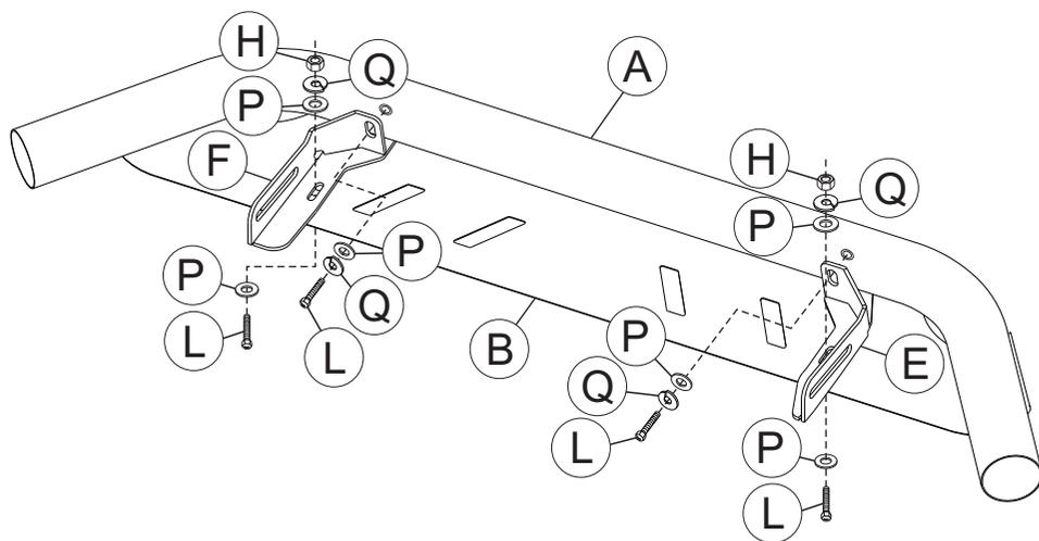
2- Montar os suportes «E e F» no tubo «A» e na chapa «B» utilizando parafusos «L» e arruelas «Q e P». Montar os suportes «E e F» no tubo «A» e na chapa «B» utilizando parafusos «L», arruelas «Q e P» e porcas «H».
