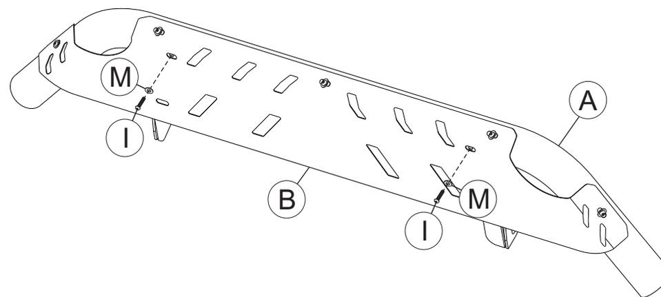
3- Montar a chapa «B» no tubo «A», utilizando para fixação os parafusos «I» e arruelas «M».
