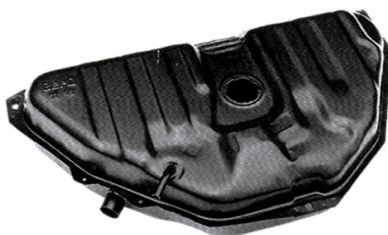
F-702 - 55 Litros (Nº Compatível: 97606737) Boia de Encaixe / Com Furo p/ Válvula / Sem 3 Tubos Compatível c/ Fiat Uno 1984...1989 Compatível c/ Fiat Fiorino 1984...1989 Compatível c/ Fiat Elba 1984...1989 Compatível c/ Fiat Prêmio 1984...1989 Medidas: 930 (comprimento) x 550 (Largura) x 200 (altura)mm
