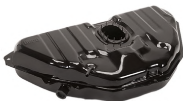
F-705 - 55 Litros (Nº Compatível: 97610255) Boia 12 Parafusos (Oval) Sem Furo p/ Válvula Sem 3 Tubos Compatível c/ Fiat Uno Fire até 1998 Compatível c/ Fiat Uno Smart até 1998 Compatível c/ Fiat Prêmio Medidas: 930 (comprimento) x 550 (Largura) x 200 (altura)mm
