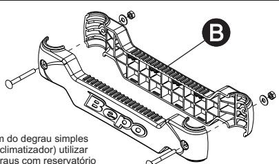
OBS: Para montagem do degrau simples (sem reservatório de climatizador) utilizar parafusos «F» e degraus com reservatório de climatizador utilizar parafusos «E».
