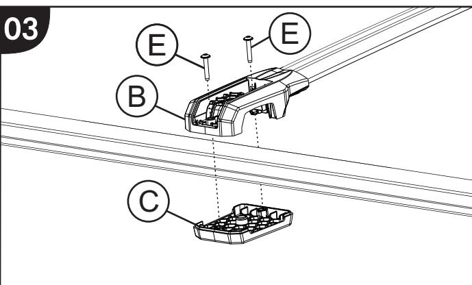
Fixar o suporte inferior 'C' junto ao suporte superior 'B', envolvendo o tubo da longarina de teto, utilizando os parafusos 'E', conforme ilustra a imagem.
