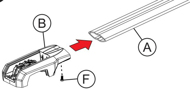
Escolha um dos lados da travessa 'A' como referência para sua montagem, encaixe e apafuse o suporte superior 'B' junto a travessa 'A', conforme ilustração, utilizando o parafuso 'F'.
