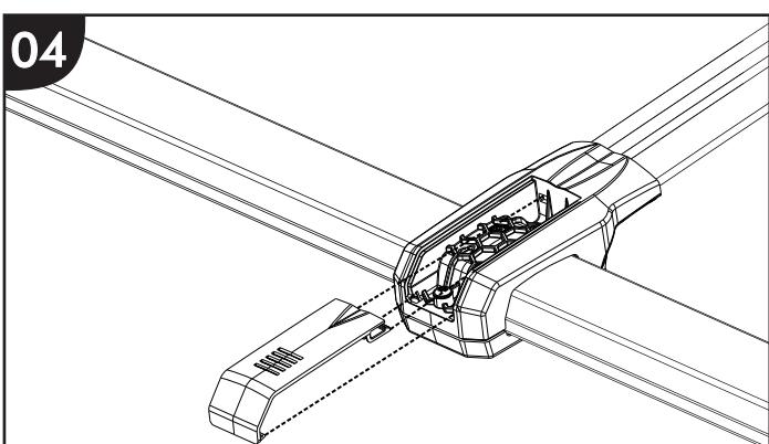
Após fixar a travessa na posição desejada encaixe a tampa 'D' conforme a figura acima.
