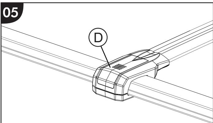
Se houver a necessidade de reposicionar a travessa, pressione a tampa 'D' conforme a figura acima para desencaixar e desaparafusar.
