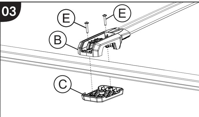
Fixar o suporte inferior 'C' junto ao suporte superior 'B', envolvendo o tubo da longarina de teto, utilizando os parafusos 'E', conforme ilustra a imagem.
