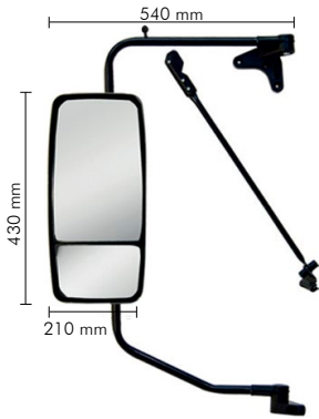
MB HPN 1634 / 1938 LS até 2012 M-039E - Espelho Completo Convexo c/ Bifocal Convexo (2 x M-026L + M-044L + M-044M)
