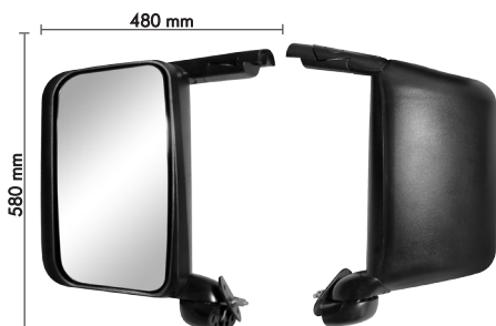
Scania P/G/R 124 S-253A - Espelho Completo Convexo Elétrico c/ Desembaçador LE Nº Orig. 1952573 S-245A - Espelho Completo Convexo LE
