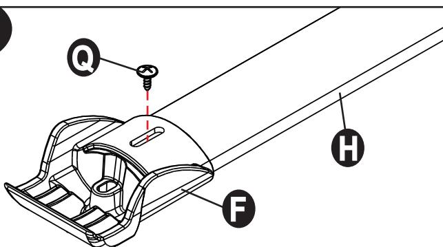
Fixar a ponteira 'F' junto ao tubo 'H', utilizando parafuso 'Q', conforme ilustra a imagem.
