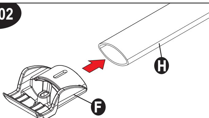
Escolha um dos lados da travessa 'H' como referência para sua montagem, encaixe a ponteira superior 'F' junto a travessa 'H', conforme ilustra a imagem.
