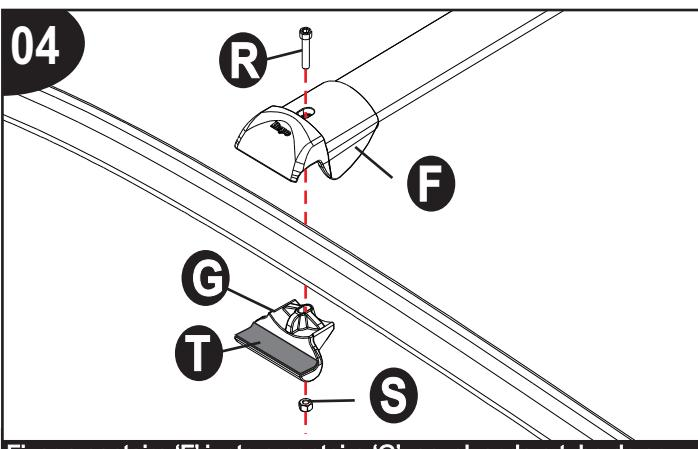
Fixar a ponteira 'F' junto a ponteira 'G', envolvendo o tubo de seu rack de teto, utilizando parafuso 'R' e porca 'S', conforme ilustra a imagem.
