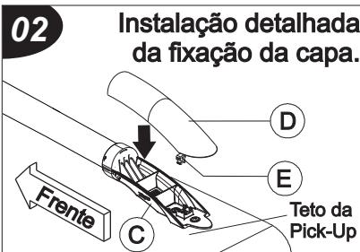
**Instalação detalhada da fixação da capa.**
