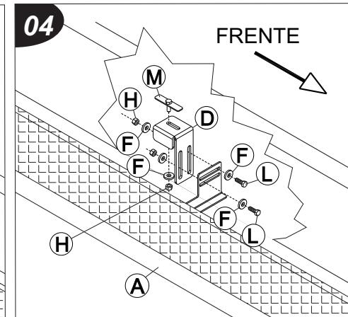
Fixar os suportes "D" e "F" no chassi do veículo utilizando para fixação as travas "M", arruelas "S" e porcas "T", após montar com o suporte do tubo utilizando para fixação os parafusos "L" arruelas "S" e porcas "T".
