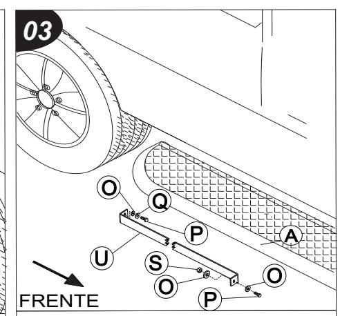
Fixe o suporte "U" no tubo usando o parafuso "P", Arruela de pressão "Q", arruela lisa "O". Fixe o suporte "U", no suporte "G" utilizando parafuso "P", arruelas "O" e porca "S".
