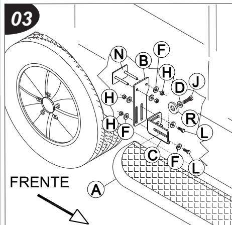
Fixar os suportes "B" no chassi do veículo utilizando para fixação a trava "N", arruelas "S" e porcas "T", após fazer montagem com o suporte "C", montar um no outro com os parafusos "L", arruelas "S" e porcas "T".
