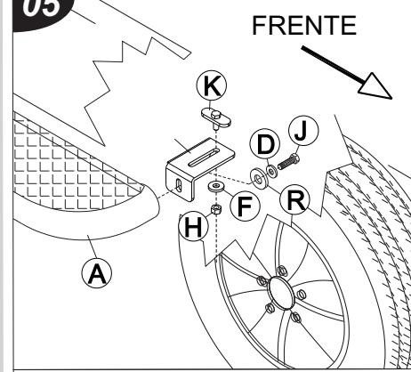
Fixar o suporte dianteiro "I" no chassi, utilizando as travas "K", arruelas "J" e porcas "R". Após fixar no estribo, utilizar os parafusos "U" com arruelas "R".
