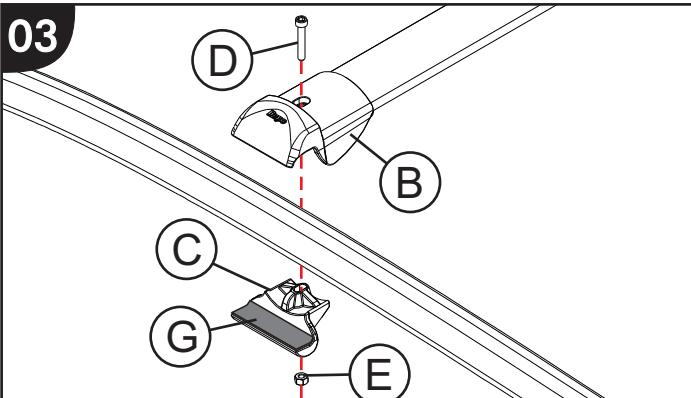
Fixar a ponteira 'C' junto a ponteira 'B', envolvendo o tubo de seu rack de teto, utilizando parafuso 'D' e porca 'E', conforme ilustra a imagem.
