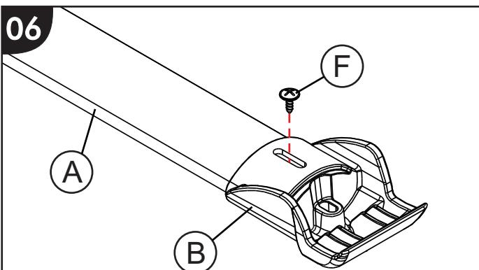
Fixar a ponteira 'B' junto ao tubo 'A', utilizando parafuso 'F', conforme ilustra a imagem.
