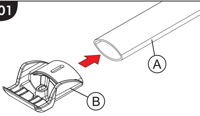
Escolha um dos lados da travessa 'A' como referência para sua montagem, encaixe a ponteira superior 'B' junto a travessa 'A', conforme ilustra a imagem.
