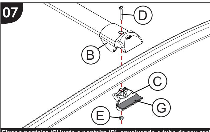
Fixar a ponteira 'C' junto a ponteira 'B', envolvendo o tubo de seu rack de teto, utilizando parafuso 'D' e porca 'E', conforme ilustra a imagem.
