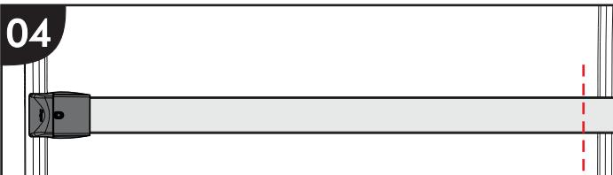
Após montagem de seu lado de referência, verificar a posição onde você deseja fixar sua travessa, e cortar a mesma na dimensão adequada para montagem, caso seja necessário.
