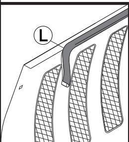
2.3 - Para impulsões com protetor de carter usar o debrum na parte superior antes de montar
