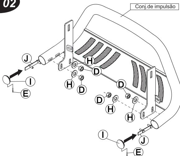
Montar o conjunto de impulsão nos suportes 'A' e 'B' já fixados no chassi, utilizando para fixação o fixador 'J', com arruelas 'H' e porcas 'D'.
