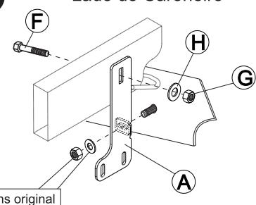
Prenda o suporte "A" e "B", no tubo passante localizado no chassi, utilizando para fixação os parafusos "F", com porcas "G", arruelas "H".
