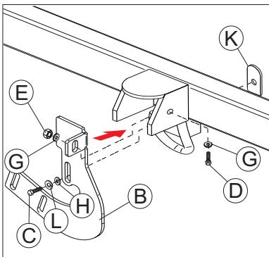
Fixar o suporte «B» utilizando para fixação os parafusos «C e D», as arruelas «G, H e L», porcas «E» e buchas «K».
