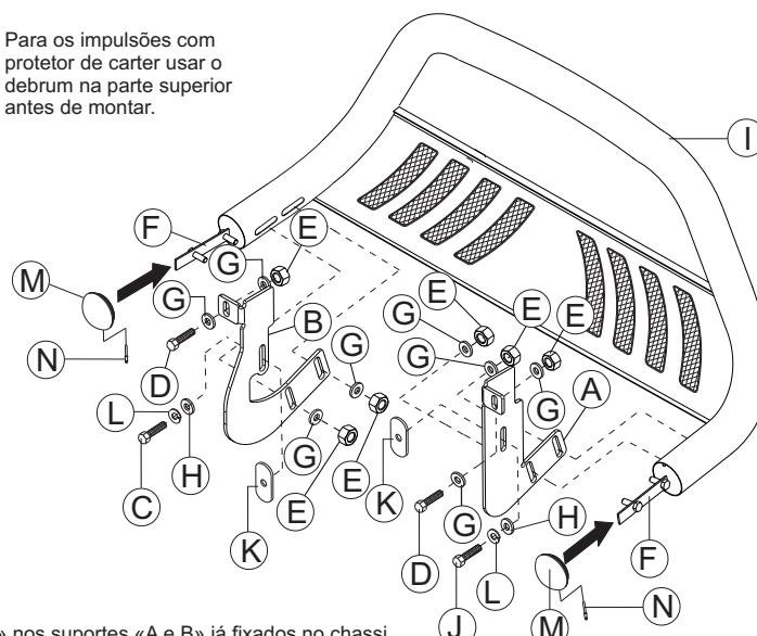
Montar o conjunto de impulsão «I» nos suportes «A e B» já fixados no chassis, utilizando para fixação, o fixador «F», com arruelas «G» e porcas «E».
