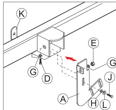
Fixar o suporte «A» utilizando para fixação os parafusos «D e J», as arruelas «G, H e L», porcas «E» e buchas «K».
