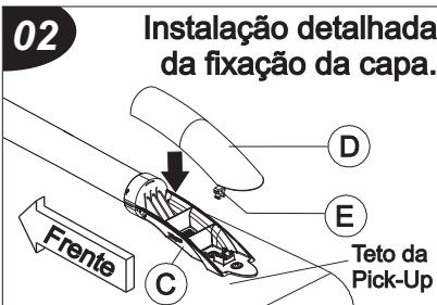
Instalação detalhada da fixação da capa.
