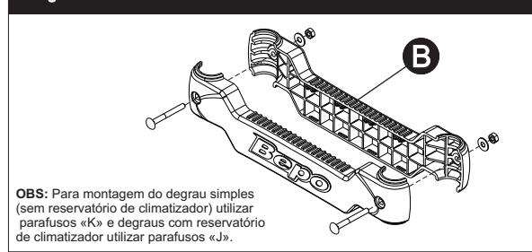
OBS: Para montagem do degrau simples (sem reservatório de climatizador) utilizar parafusos «L» e degraus com reservatório de climatizador utilizar parafusos «J».
