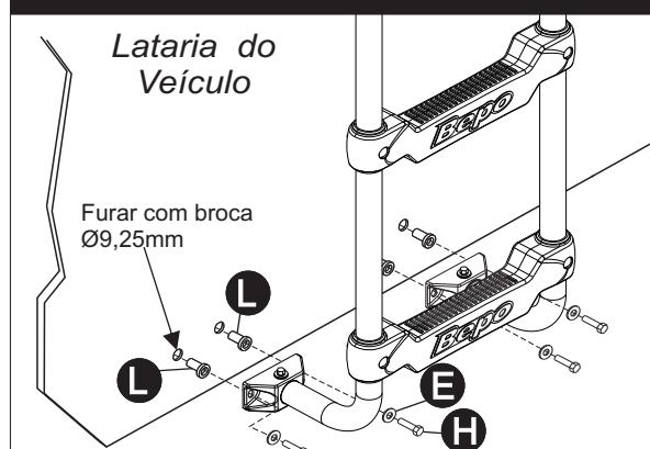
Para montagem do degrau da escada, proceder conforme ilustrado na figura abaixo.
