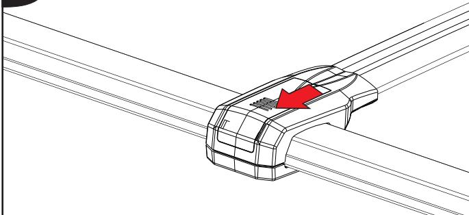
Se houver a necessidade de reposicionar a travessa, pressione a tampa 'E' conforme a figura acima para desencaixar e desaparfusar.
