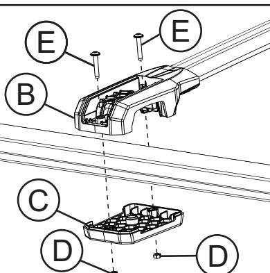
Fixar o suporte inferior 'C' junto ao suporte superior 'B', envolvendo o tubo da longarina de teto, utilizando parafuso 'F' e porca 'D', conforme ilustra a imagem.
