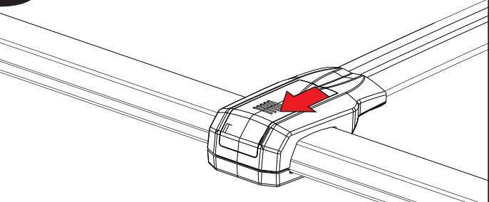
Se houver a necessidade de reposicionar a travessa, pressione a tampa 'E' conforme a figura acima para desencaixar e desapafusar.
