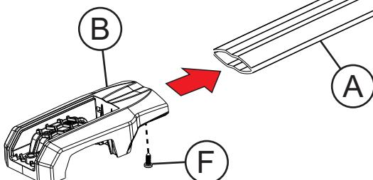
Escolha um dos lados da travessa 'A' como referência para sua montagem, encaixe e apafuse o suporte superior 'B' junto a travessa 'A' conforme ilustração, utilizando o parafuso 'G'.
