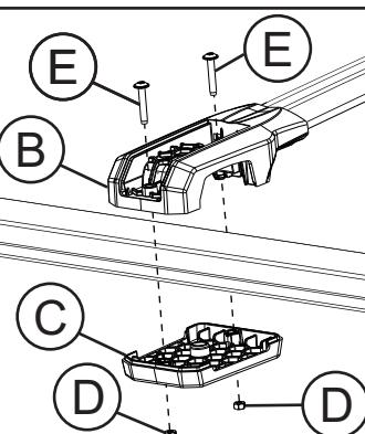
Fixar o suporte inferior 'C' junto ao suporte superior 'B', envolvendo o tubo da longarina de teto, utilizando parafuso 'F' e porca 'D', conforme ilustra a imagem.
