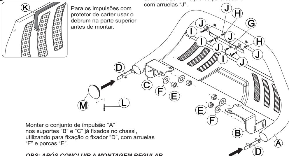
Montar o conjunto de impulsão "A" nos suportes "B" e "C" já fixados no chassi, utilizando para fixação o fixador "D", com arruelas "F" e porcas "E".
