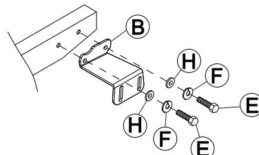
1. Retirar os parafusos originais da pick-up situados na ponta do chassi logo a frente do radiador na parte inferior.
