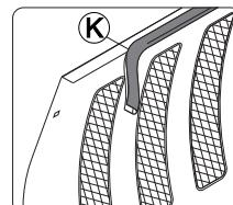
Para os impulsão com protetor de cárter usar o debrum na parte superior antes de montar.
