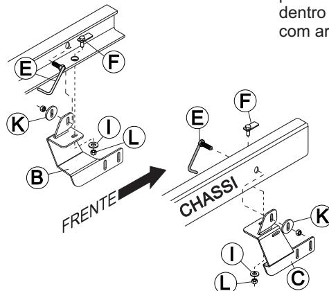
Montar o suporte do chassi "B" e "C" utilizando para fixação as travas 'E' e 'F' passando-a por dentro do chassi e fixando os suportes 'B' e 'C' com arruelas 'K' e 'I' e porcas 'L'.
