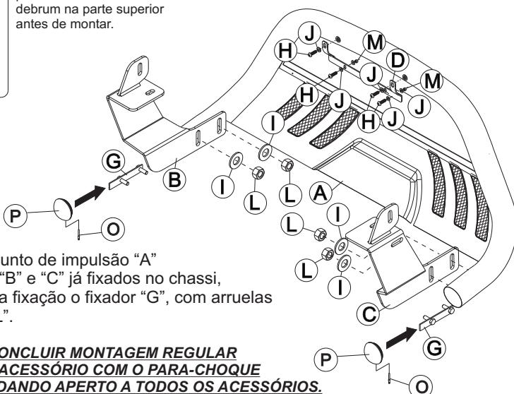
Montar o conjunto de impulsão "A" nos suportes "B" e "C" já fixados no chassi, utilizando para fixação o fixador "G", com arruelas "I" e porcas "L".
