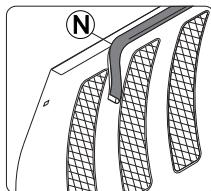
Para os impulsão com protetor de cárter usar o debrum na parte superior antes de montar.
