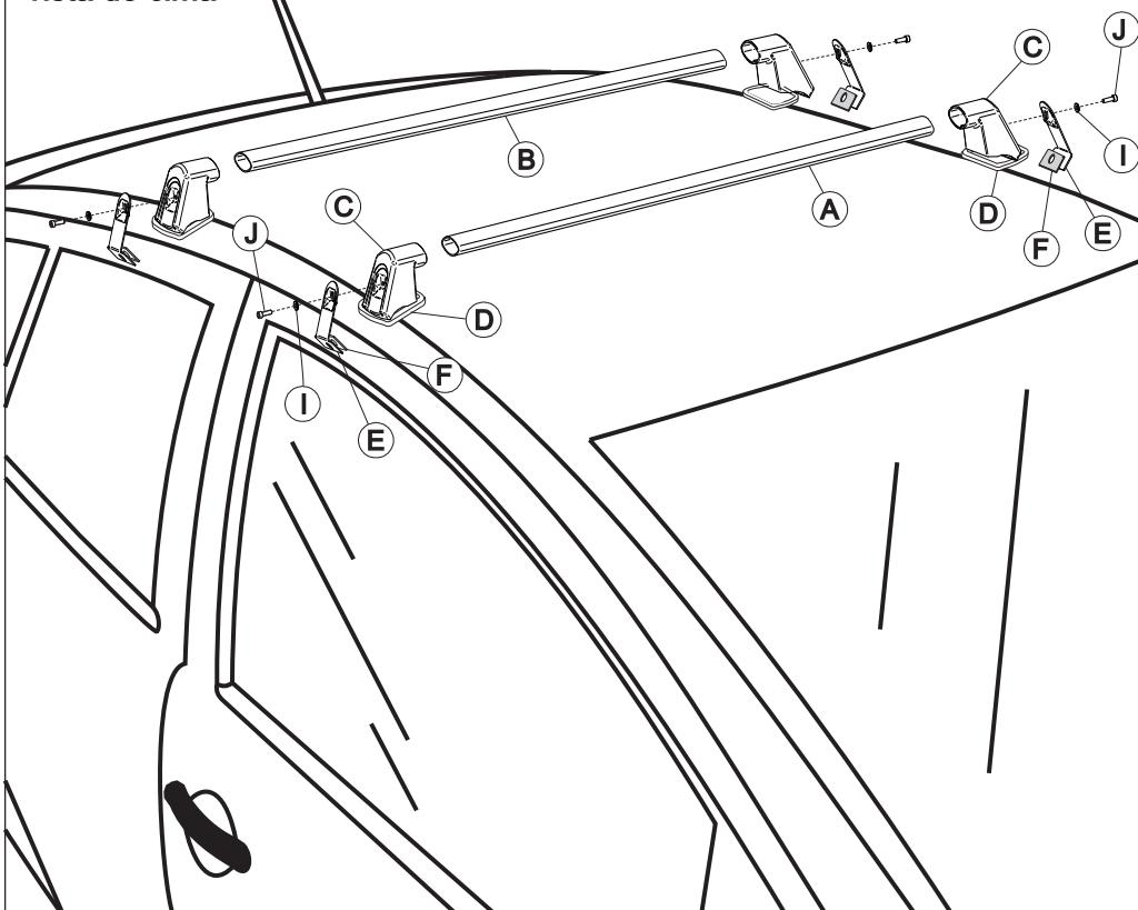
Localizar dentro de cada peça o adesivo que indica qual a posição da base no teto do veículo:
