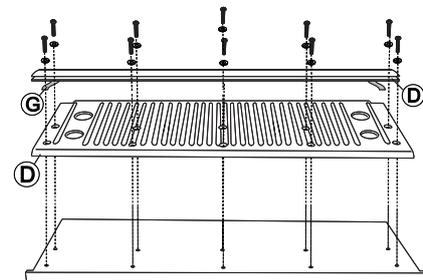
1. Retire as pontas do dupla-face, deixando um pedaço para fora, e encaixe o perfil de alumínio 'D' na tampa.
