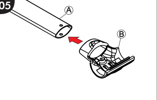
Montar o conector superior 'B' junto a travessa 'A', conforme ilustra a imagem.
