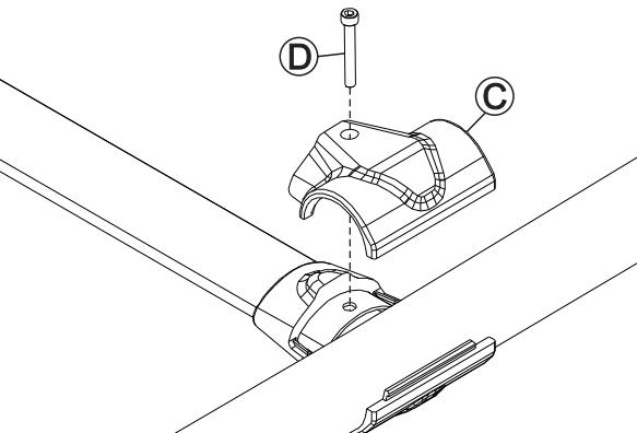
Montar o conector 'C' junto ao conector 'B' envolvendo o tubo do seu rack, utilizando parafuso 'D', conforme ilustra a imagem.
