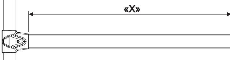
Após montagem de seu lado de referência, verificar a posição onde você deseja fixar sua travessa, e cortar a mesma na dimensão adequada para montagem, caso seja necessário.
