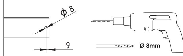
Após definir o comprimento de sua travessa, marcar a furação para fixação dos conectores plásticos 'B' e 'C' e furar utilizando broca Ø8mm, seguir dimensões indicadas acima.
