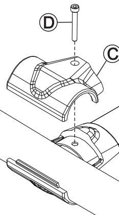
Fixar o Conector 'C' junto ao conector 'B', envolvendo o tubo cilíndrico de seu rack te teto, utilizando parafuso 'D', conforme ilustra a imagem.
