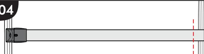
Após montagem de seu lado de referência, verificar a posição onde você deseja fixar sua travessa, e cortar a mesma na dimensão adequada para montagem, caso seja necessário.
