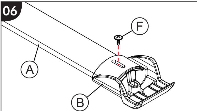
Fixar a ponteira 'B' junto ao tubo 'A', utilizando parafuso 'F', conforme ilustra a imagem.
