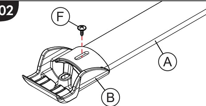
Fixar a ponteira 'B' junto ao tubo 'A', utilizando parafuso 'F', conforme ilustra a imagem.
