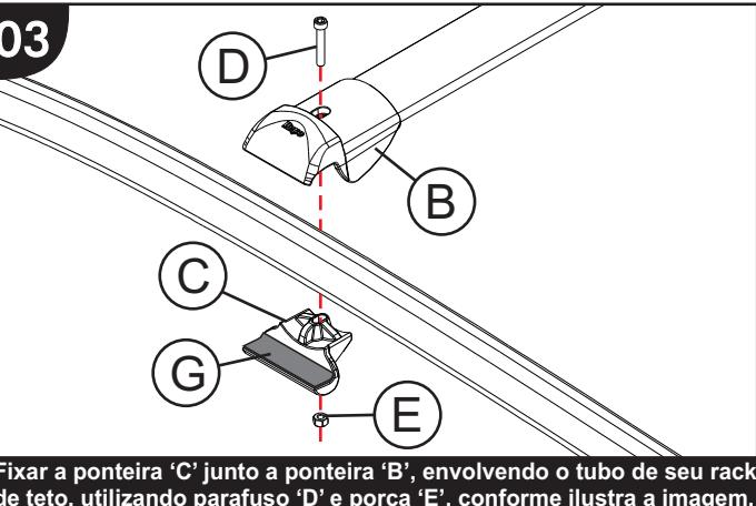
Fixar a ponteira 'C' junto a ponteira 'B', envolvendo o tubo de seu rack de teto, utilizando parafuso 'D' e porca 'E', conforme ilustra a imagem.
