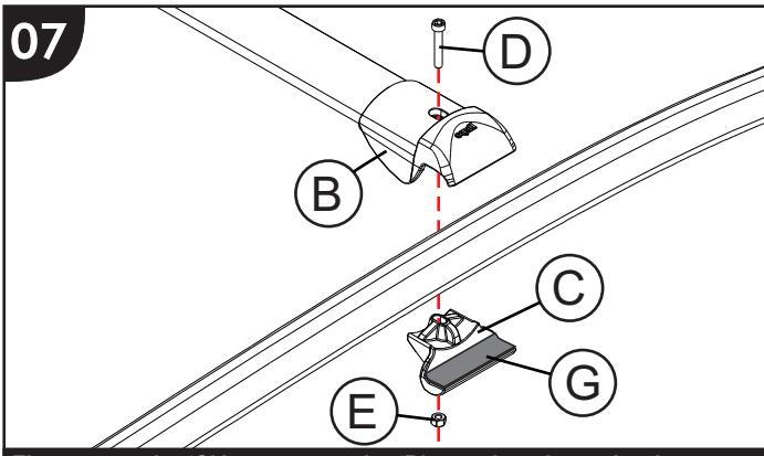
Fixar a ponteira 'C' junto a ponteira 'B', envolvendo o tubo de seu rack de teto, utilizando parafuso 'D' e porca 'E', conforme ilustra a imagem.
