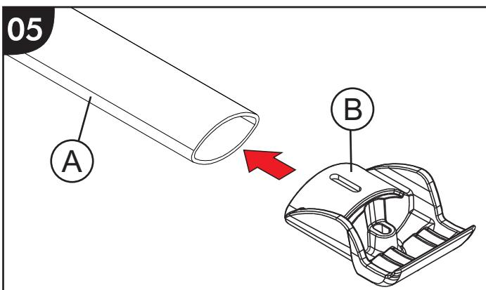
Escolha um dos lados da travessa 'A' como referência para sua montagem, encaixe a ponteira superior 'B' junto a travessa 'A', conforme ilustra a imagem.
