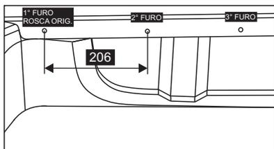
OBS: PARA MONTAR ESSA BASE, É NECESSÁRIO VERIFICAR SE HÁ O 2º FURO, OU SE DEVERÁ SER FEITO. CASO PRECISE REALIZAR A FURAÇÃO, FAVOR SEGUIR A MEDIDA INDICADA, FURANDO COM UMA BROCA DE Ø11,25 MM. NO PRIMEIRO FURO A ROSCA É ORIGINAL, JÁ AO REALIZAR O 2º OU 3º, PORCAS E ARRUELAS DEVERÃO SER UTILIZADAS.
