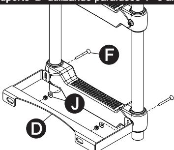
Fixe a escada no chassi do veículo utilizando parafusos e arruelas originais.
