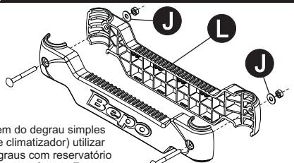
OBS: Para montagem do degrau simples (sem reservatório de climatizador) utilizar parafusos «E» e degraus com reservatório de climatizador utilizar parafusos «F».
