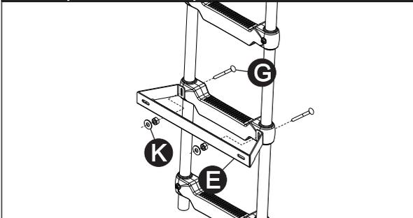
Fixe a escada no chassi do veículo utilizando parafusos e arruelas originais.
