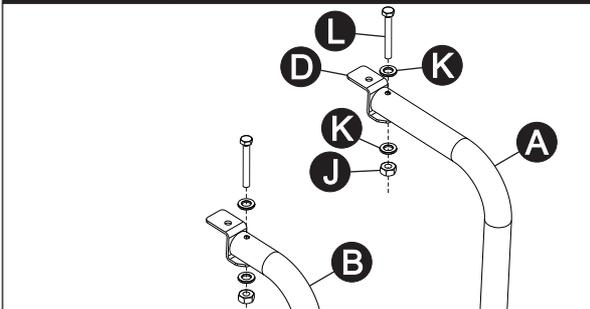
Fixe os suportes 'C' e 'D' no caminhão utilizando parafusos 'I', arruelas 'K' e porcas 'H'.
