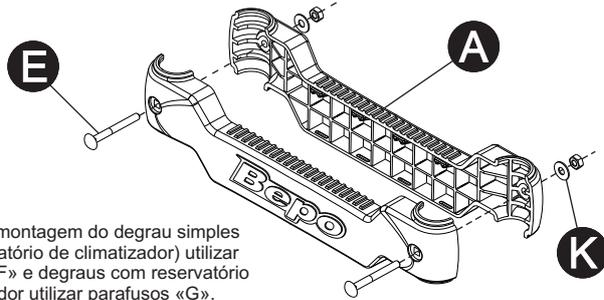
OBS: Para montagem do degrau simples (sem reservatório de climatizador) utilizar parafusos «F» e degraus com reservatório de climatizador utilizar parafusos «G».
