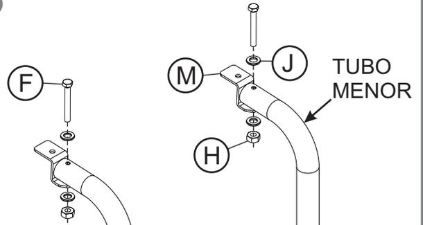
Fixe a orelha 'M' no tubo da escada utilizando parafusos 'F', arruelas 'J' e porcas 'H'.
