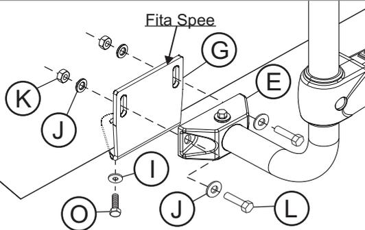
Fixe a tubo lateral com o suporte 'G' e pé plástico 'E' utilizando parafusos 'L', arruelas 'J' e porcas 'K'. Fixe o suporte 'G' por baixo do chassi utilizando parafuso 'O' e arruela 'I'.
