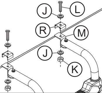
Fixe os suportes 'M' e 'R' no caminhão utilizando parafusos 'L', arruelas 'J' e porcas 'K'.
