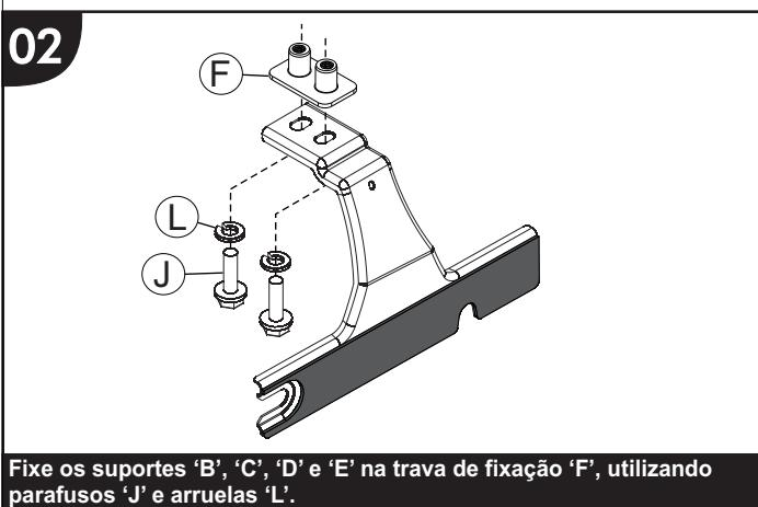
Fixe os suportes 'B', 'C', 'D' e 'E' na trava de fixação 'F', utilizando parafusos 'J' e arruelas 'L'.
