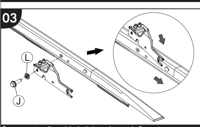
Remova os tampões originais da longarina e após fixe as travessas utilizando parafusos 'J' e arruela 'L'.
