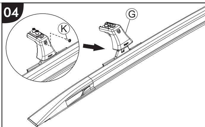
Encaixe a capa plástica 'G' nos suportes utilizando parafusos 'K'.
