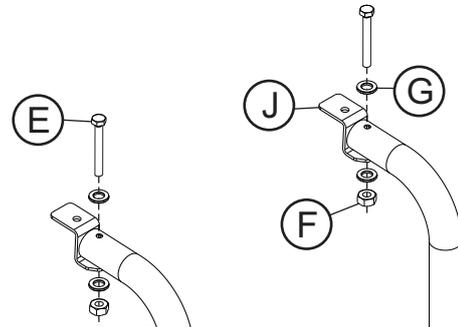
Fixe a orelha 'J' no tubo da escada utilizando parafusos 'E', arruelas 'G' e porcas 'F'.
