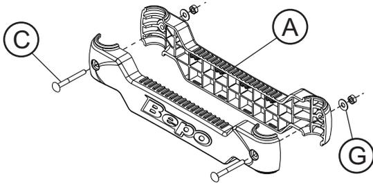
Para montagem do degrau da escada, proceder conforme ilustrado na figura abaixo.
