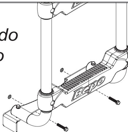
Fixar o suporte inferior 'L' nos furos originais do veículo utilizando parafusos originais.
