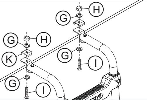
Fixe os suportes 'J' e 'K' no caminhão utilizando parafusos 'I', arruelas 'G' e porcas 'H'.
